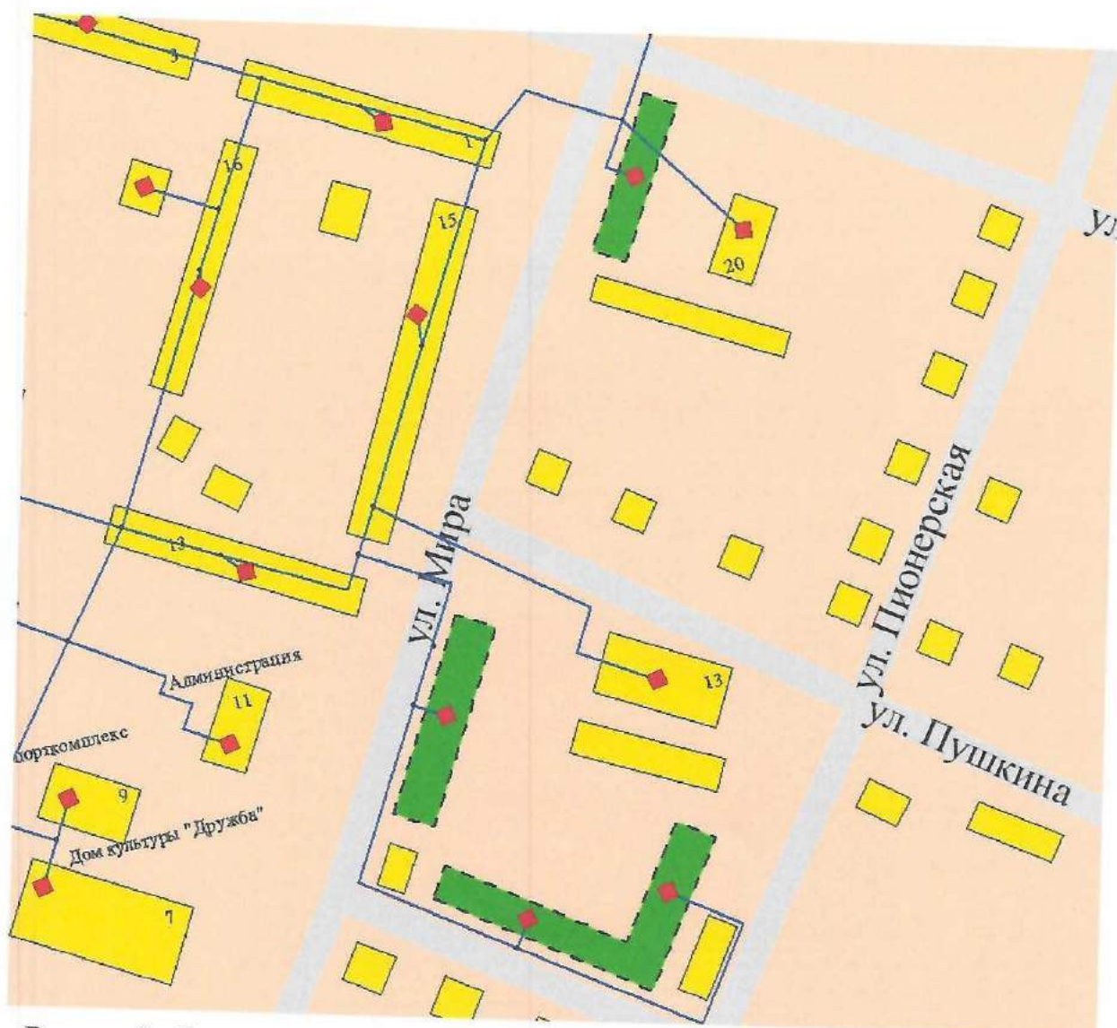
Рисунок 8 – Вариант трассировки тепловых сетей к перспективным потребителям
